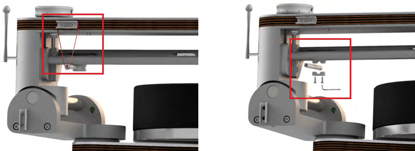
Abb. 8: Entfernen der Transportsicherung
