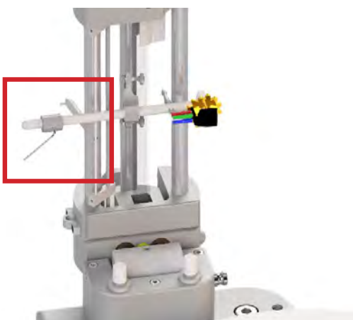
Abb. 21: Befestigen der Gegengewichte
