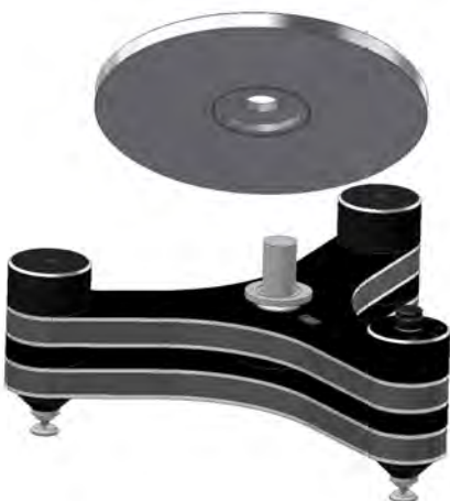
Abb. 8: Montage des Subtellers mit Skalenring
