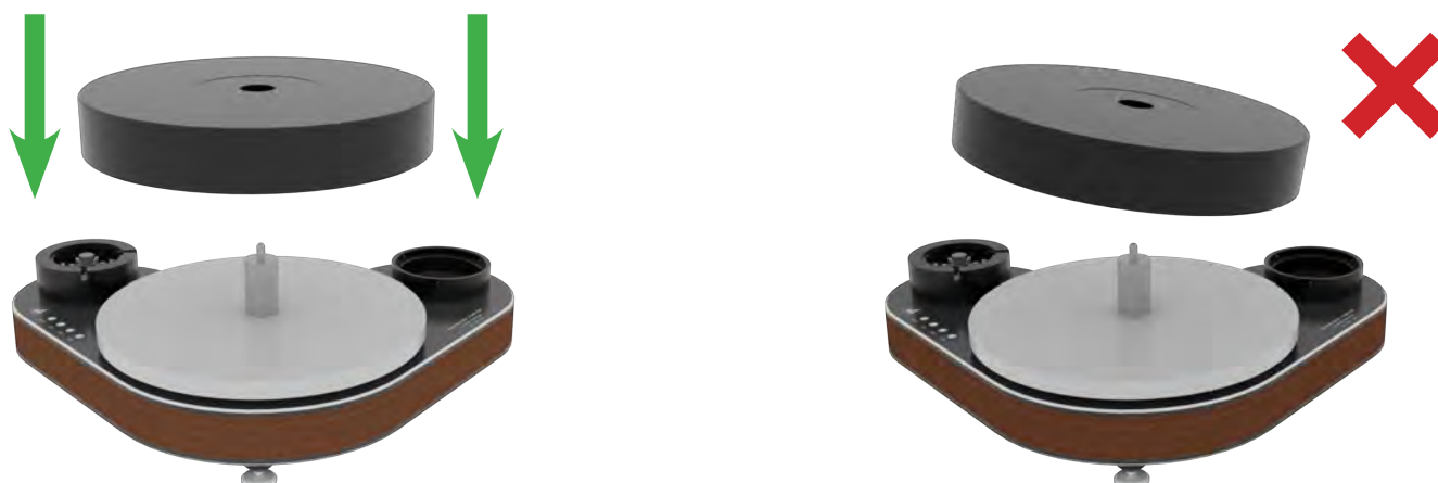
Abb. 10: Aufsetzen des Plattentellers
